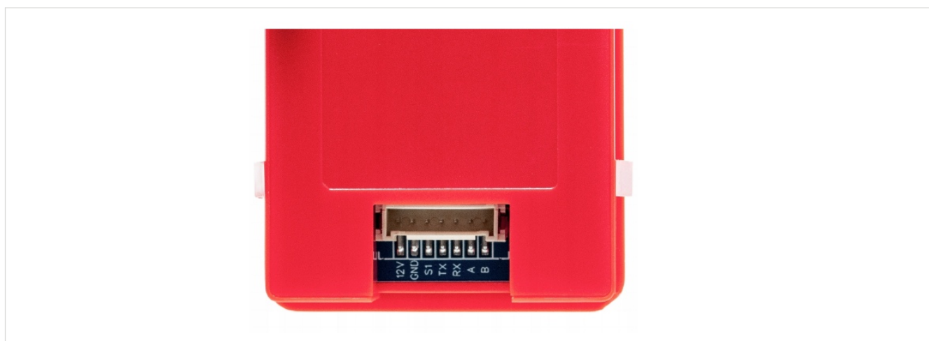
Разъем дисплея с маркировкой контактов 12V, GND, ST, RX, TX, A и B.
