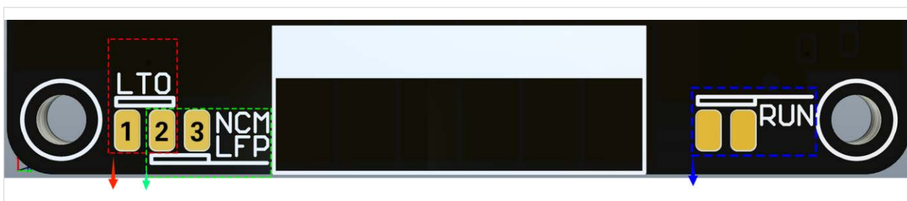
Площадки 1-2-3 для выбора химии и контакты RUN для внешнего выключателя.
