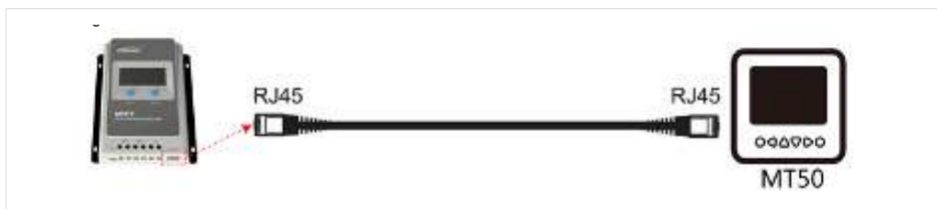
Соединение контроллера с панелью MT50 стандартным сетевым кабелем RJ45.
