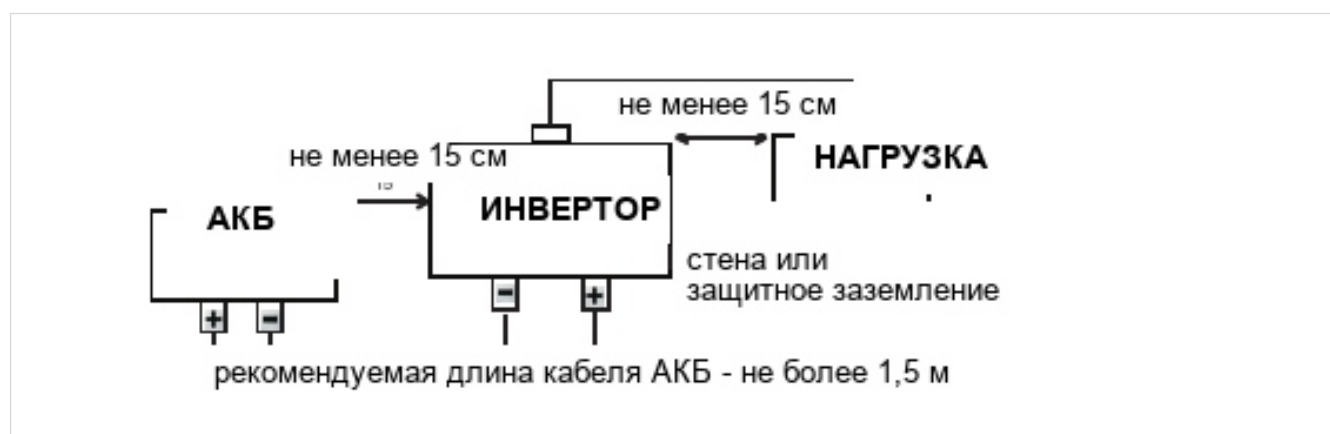
Подключение батареи, инвертора и нагрузки.
