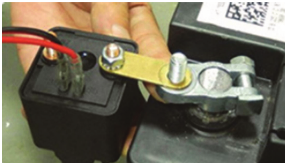
Соединение вывода 30 с аккумуляторной клеммой
