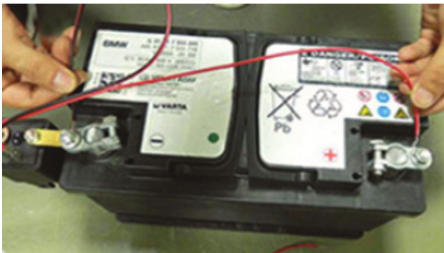
Подключение тонких проводов питания приёмника
