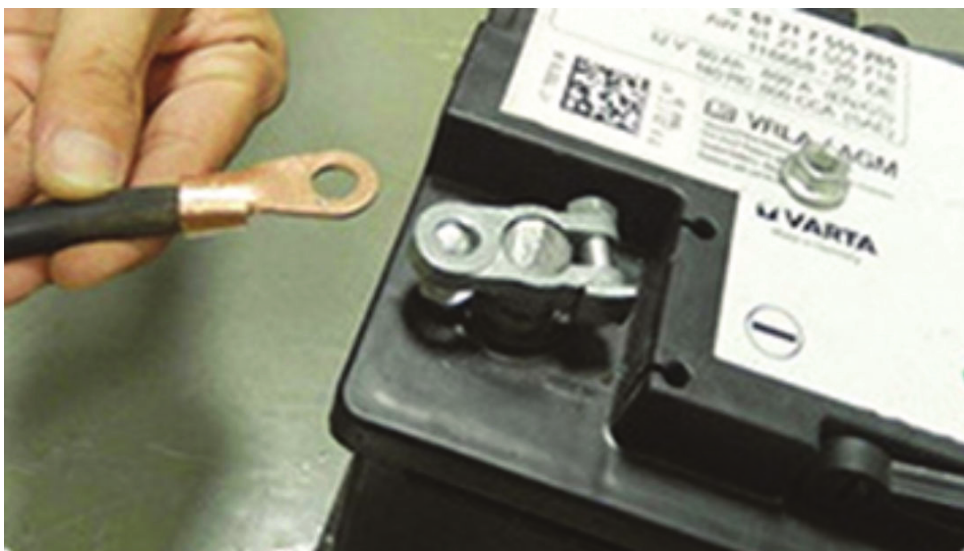
Отсоединение исходного силового кабеля
