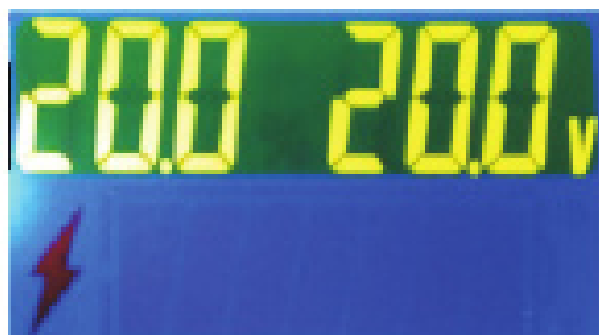
Экран калибровки при эталонном напряжении 20,0 В.
