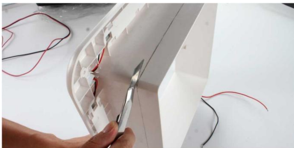
Подгонка внутренней рамки по толщине крыши
